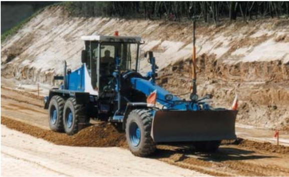
und Neigung für den entsprechenden Punkt aus dem zuvor gespeicherten digitalen Geländemodell an. Mithilfe der Maschinensteuerung bewegt der Führer das Schild oder die Schaufel in den richtigen Arbeitswinkel zum Einbau oder dem präzisen Abtrag. Ist die Maschine mit einer automatischen Schildsteuerung ausgerüstet, reagiert das System automatisch und passt die Schildposition entsprechend an.
